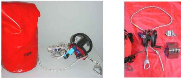
Figure : Dispositif de descente en rappel et de sauvetage pour 2 personnes (ENERCON 2011)
